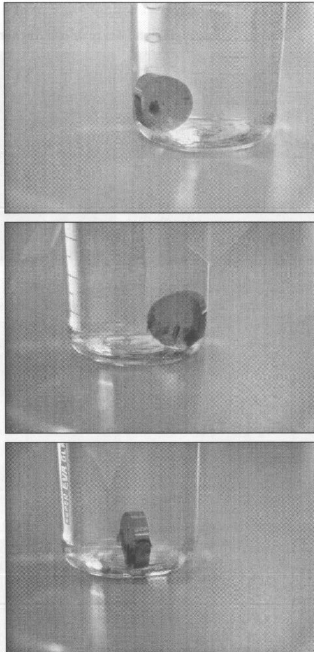
Figura 16 – Aspetto di un dischetto di AISI 316L dopo 3 giorni di immersione in Anolita non diluito a temperatura ambiente.
